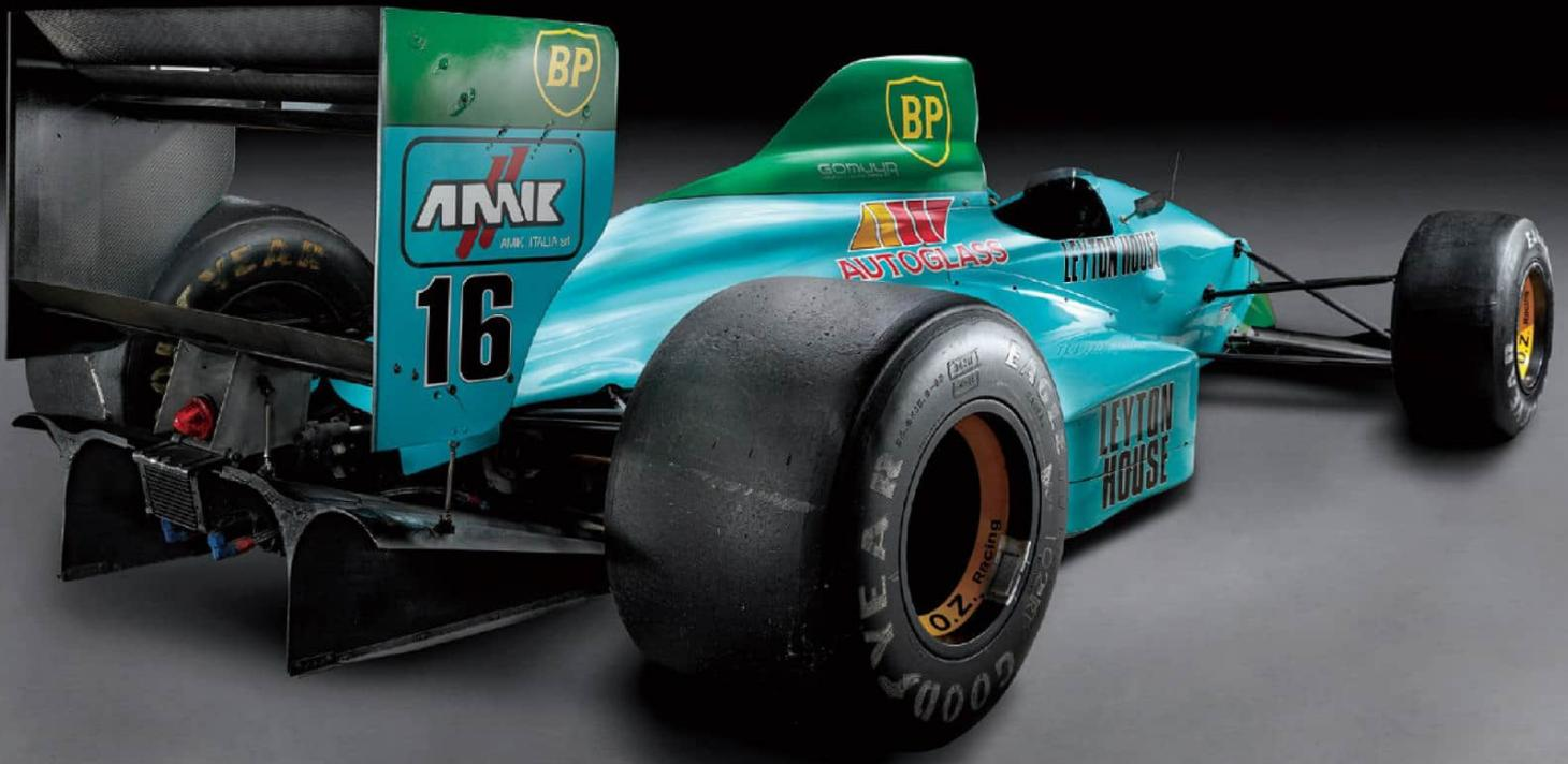
1内部のフットスペースがわずかに25cmしかなかったとされる極細ノーズや2特徴的な形状のリヤディフューザー、3極低のサイドポンツーンなどすべてが革新的デザインだった881。ちなみにサイドポンツーンは89年になると冷却系の改良により撮影個体よりも少し大型化されている。
