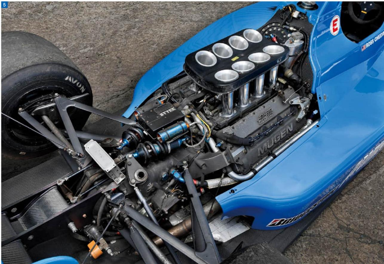
1 リヤウイングの上側は鈴鹿・SUGOなどの仕様、下側のウイングは富士などに採用された一枚もの。2 92年モデルに比べて大型化されたフロントウイングの翼端板にはポーターテックスジェネレーターが装着されている。3 4 93Dのサイドポンツーン。右側のサイドポンツーンのモノコック側にバッテリーを搭載。左側の青いボックスはサイテックのECU。5 93Dのリヤセクション。搭載エンジンは無限MF308、リヤカウルは頭頂部より吸気される。横置きギヤボックス採用のためミッションケースがコンパクトに。サスペンション形式は前後プッシュロッド。
