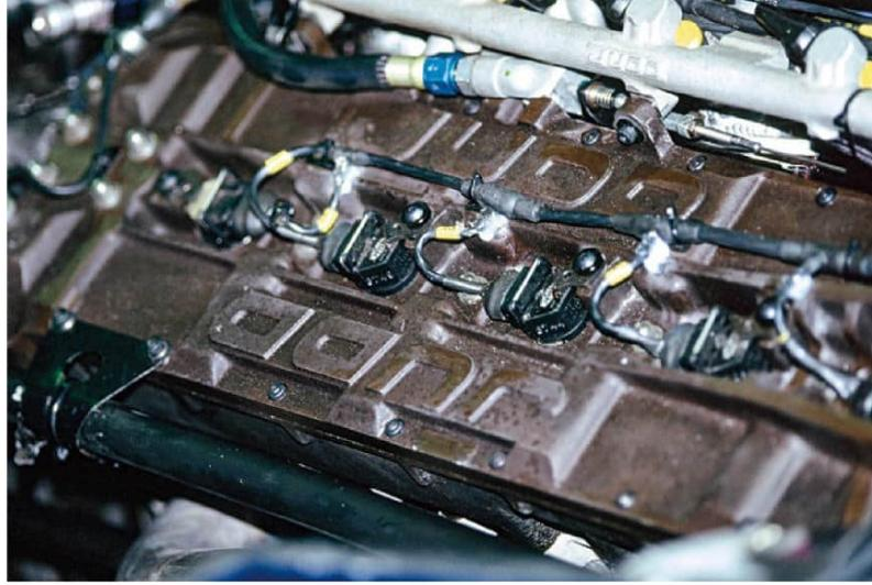
92年の搭載エンジンとなったジャッドのV10、GV。もともとジャッドはブラバムのために活動を開始したエンジンビルダーであり、最後のエンジンになったのは何かの縁か。
